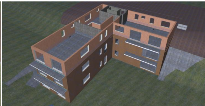
Obrázek 17 Zapažení a vysypání zeminou v oblasti kotev a paralelně probíhající výstavba 1NP z keramických tvárnic
