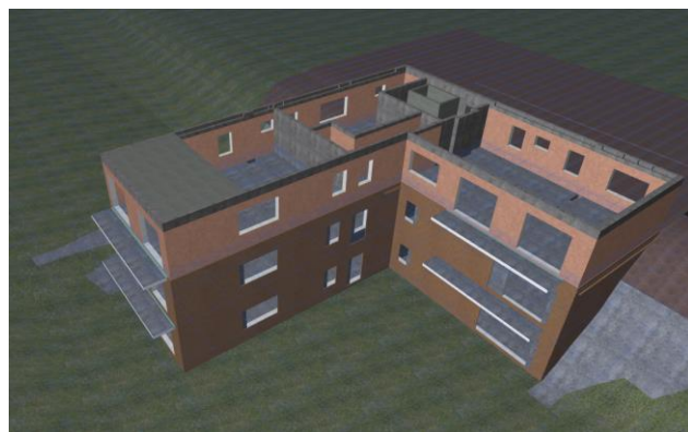
Obrázek 20 Osazení filigránovými deskami a převázání výztuže z balkónu
